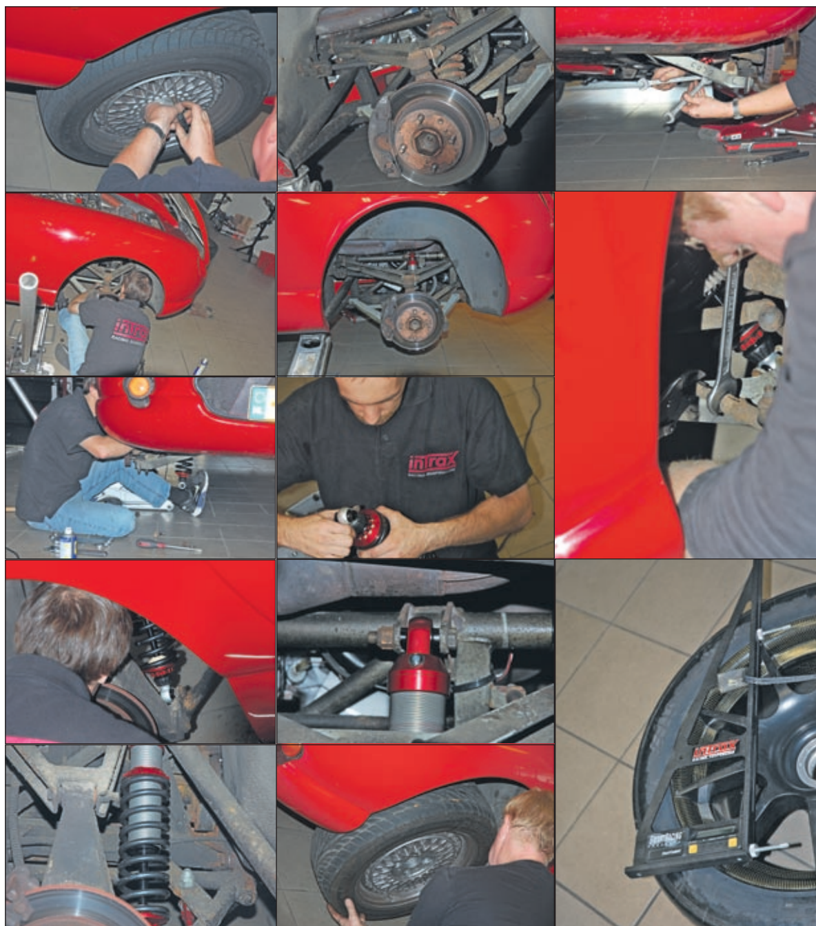
De Intrax dempers zijn aan de wielophanging bevestigd met 'uniballs' in plaats van de rubbers van de oude units. 'Dat verschil ga je straks goed merken', zeggen de mannen van Intrax. de montage verloopt voorspoedig; alleen de 'upright' rechtsachter zit iets in de weg.
